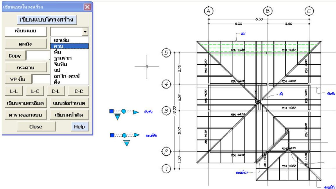
หมายเหตุ ต้อง Copy Gridline และ เสา มาที่ชั้นหลังคาก่อน
