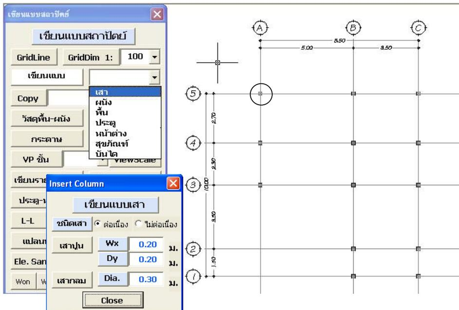
เลือกชนิดเสา ขนาดเสา (Wx แนวนอน, Dy แนวตั้ง)คลิกที่ "เสาปูน"หรือ "เสากลม" เลือกตำแหน่งเขียนเสา จากนั้น Copy เสาไปตามตำแหน่งเสา
